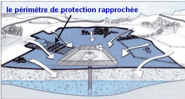
Le périmètre de protection rapprochée doit protéger efficacement le captage vis-à-vis de la migration souterraine de substances polluantes. Sa surface dépend des caractéristiques de l'aquifère, des débits de pompage, de la vulnérabilité de la nappe. En France, le temps de transfert entre la pollution et le captage retenu est d'environ 50 jours, ce qui représente suivant les terrains une surface comprise entre 1 et 10 hectares.
